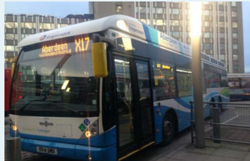
Abbildung: Ein wasserstoffbetriebener Van Hool-Bus an der Union Square Bus Station, Aberdeen, Schottland. Quelle: Wikimedia commons, Aifweb 2015, https://commons.wikimedia.org/wiki/File:Hydrogen_Bus_Aberdeen.jpg , CC BY-SA 4.0
